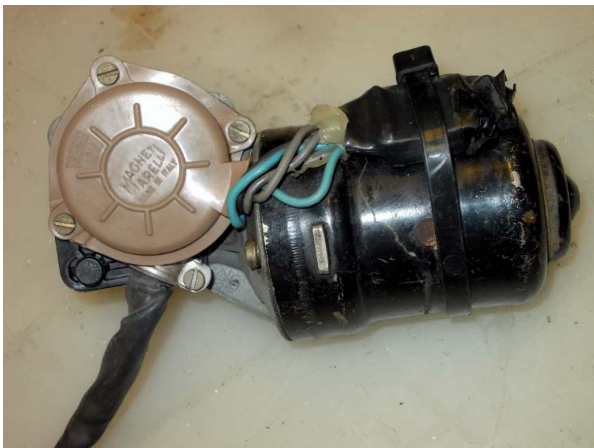
Abb.: 73 DSCN2812-Wischermotor Magneti Marelli TGE568.JPG
