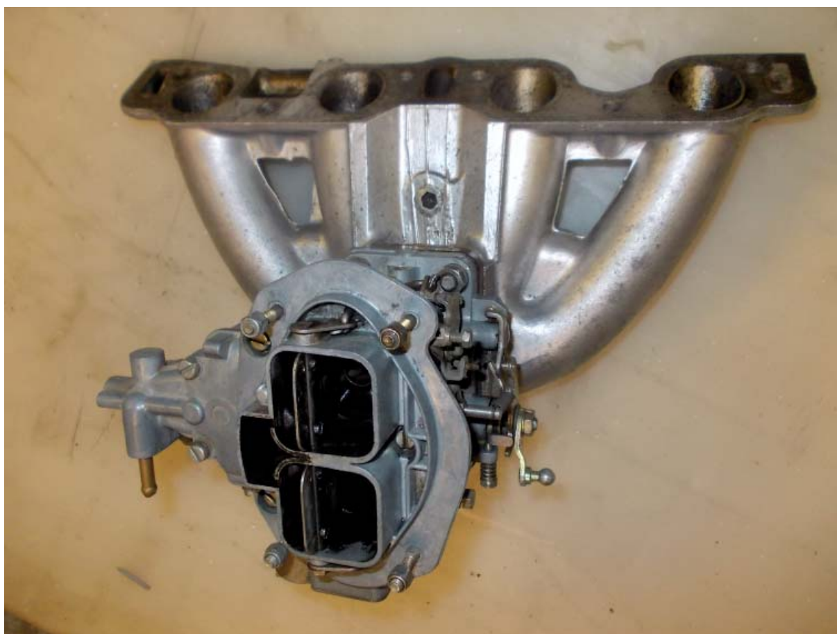
Abb.: 69 DSCN2789-Vergaser Weber+Ansaugbrücke.JPG
