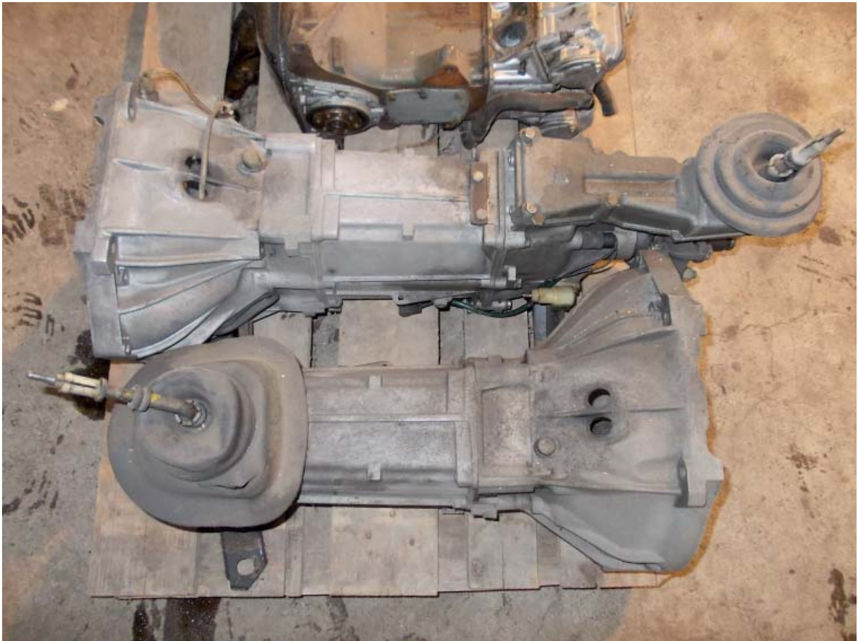
Abb.: 59 DSCN2759-Getriebe 132 5Gang+Argenta.JPG
