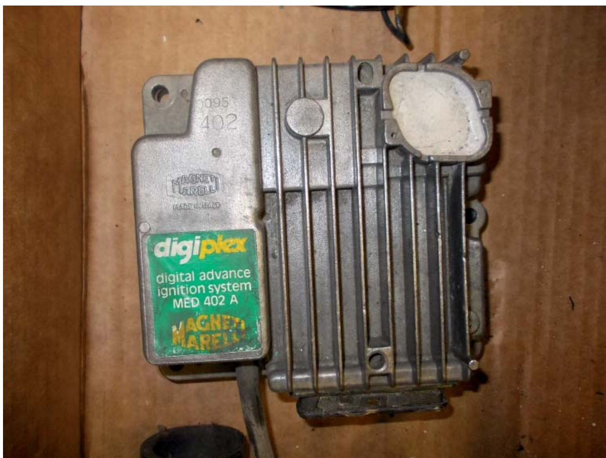
Abb.: 52 DSCN3495-Motorsteuerung digiplex med402A magneti marelli.JPG
